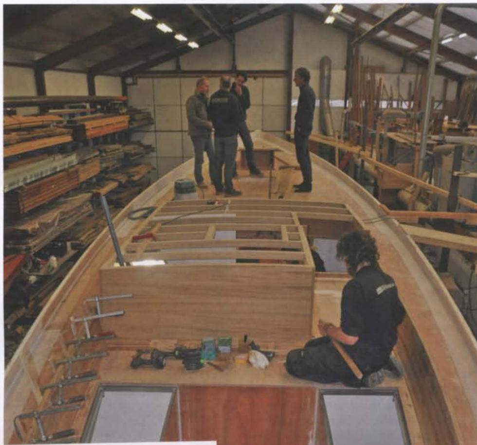
links: In de timmerhal bij Ventis, de kuiprand wordt gemonteerd en men is bezig met het interieur
