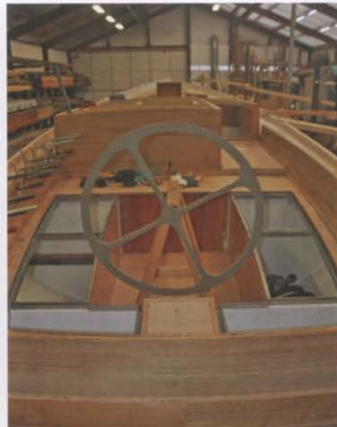
links: In de timmerhal bij Ventis, de kuiprand wordt gemonteerd en men is bezig met het interieur
