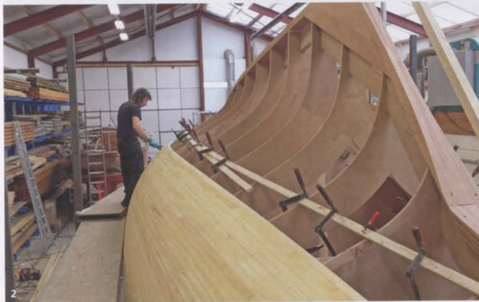
Chronologische volgorde van de werkzaamheden: 1 De bouwspanten zijn geplaatst • 2 Over de bouwspanten, die als "mal" fungeren, worden latten gelijmd, ze vormen de houten kern van het laminaat waaruit de romp zal bestaan • 3 De romp is klaar en wordt gedraaid om de spuithal in te gaan (4) • 5 De indeling van het interieur wordt gereed gemaakt • 6 De dekbalken liggen er in, nu kan er een plywood onderlaag op en daarna een teakdek
