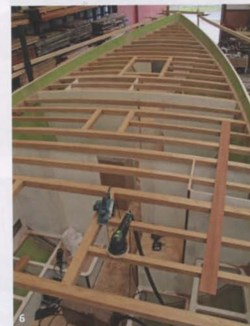
Chronologische volgorde van de werkzaamheden: 1 De bouwspanten zijn geplaatst • 2 Over de bouwspanten, die als "mal" fungeren, worden latten gelijmd, ze vormen de houten kern van het laminaat waaruit de romp zal bestaan • 3 De romp is klaar en wordt gedraaid om de spuithal in te gaan (4) • 5 De indeling van het interieur wordt gereed gemaakt • 6 De dekbalken liggen er in, nu kan er een plywood onderlaag op en daarna een teakdek
